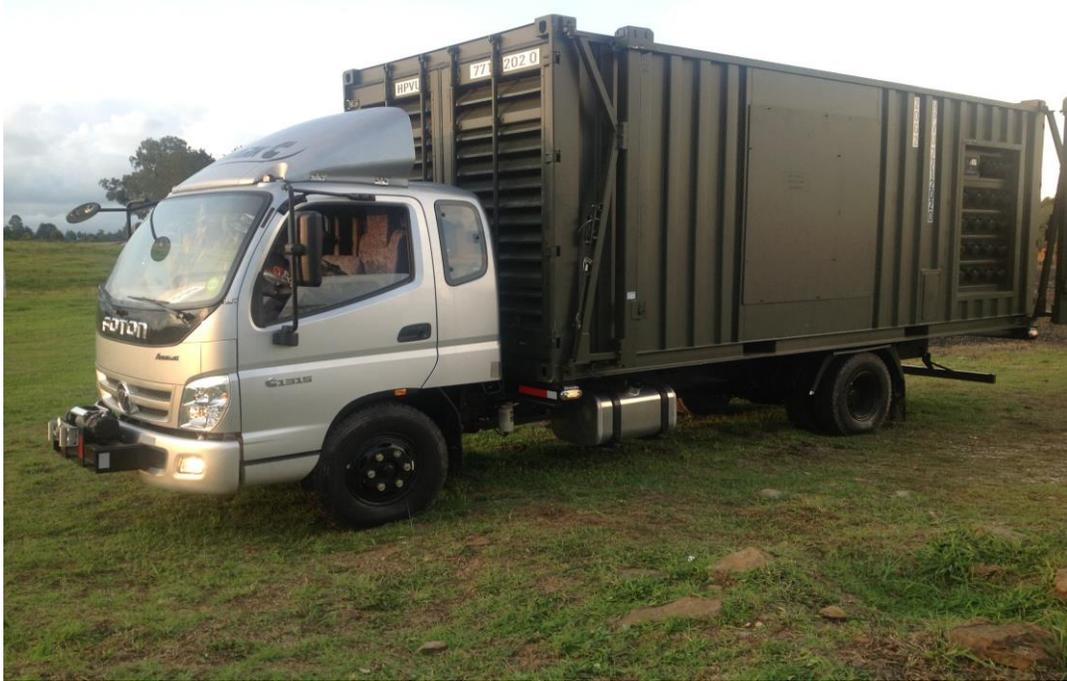
Ilustración 7. Camión cargado con contenedor planta eléctrica. Fuente. Autor, 2013
