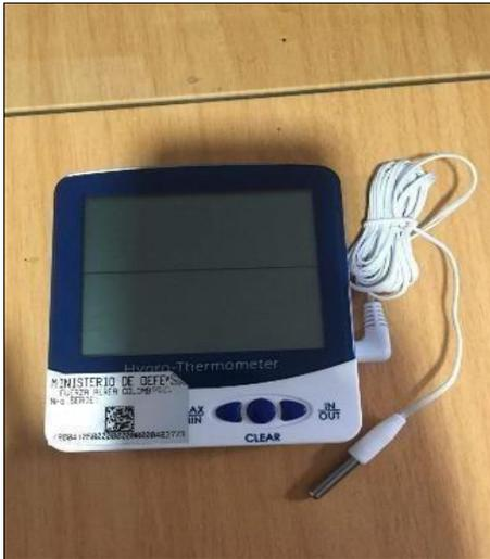
Instrumento de medición de Temperatura y Humedad
