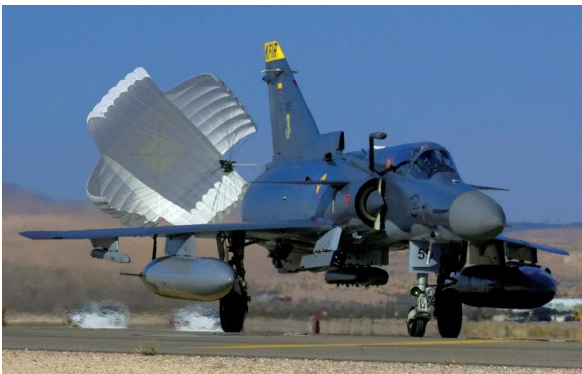
Figura 39. Kfir con su paracaídas de frenado desplegado durante aterrizaje en Red Flag
