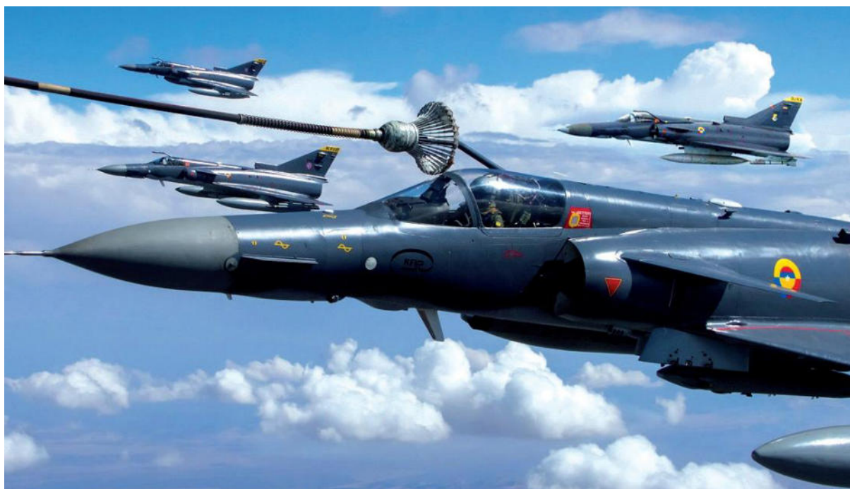
Figura 24. Kfir C10 reabasteciéndose en vuelo, acompañado por tres aeronaves del mismo tipo
